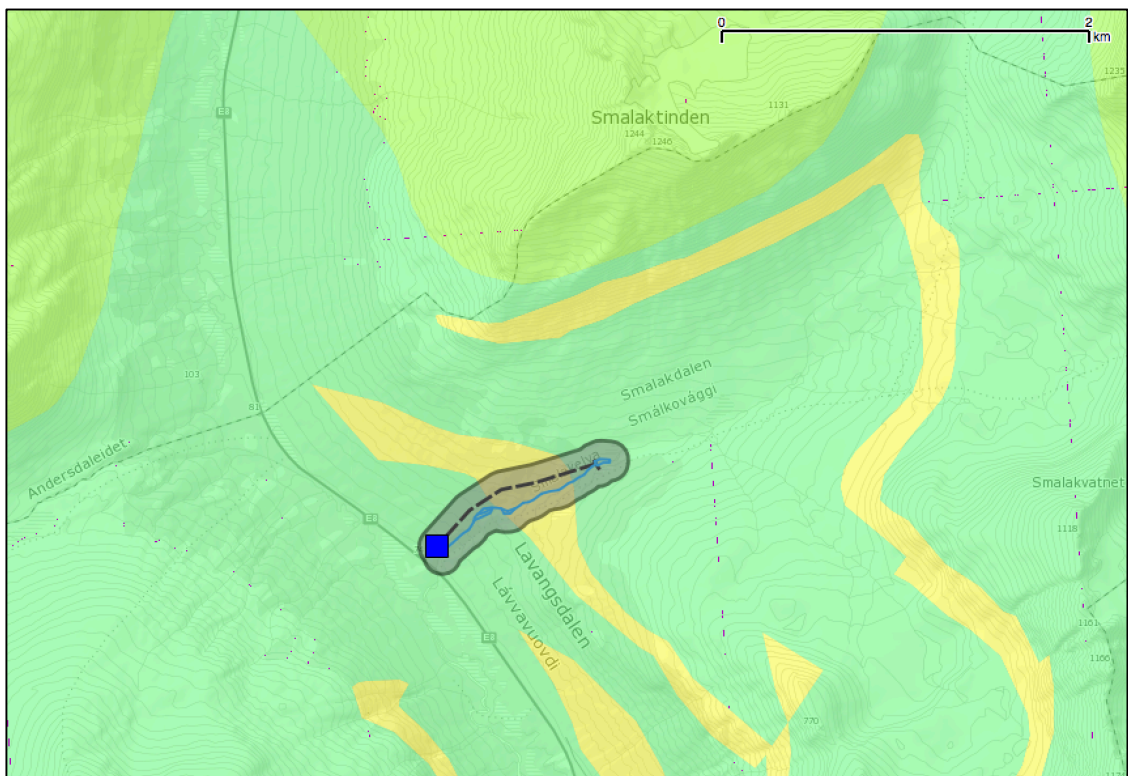
Figur 8. Berggrunnskart over store deler av nedslagsfeltet til Smalakelva. Granatklorittglimmerskifer (grønn farge) dominerer i området. Dette er en bergart som kan være noe variabel i forvitringsgrad. Stedvis kan den gi baserike forhold. Innimellom er det kvartsitt (gul farge). Dette er en hard bergart som gir sure substrater. Kilde: Norges geologiske undersøkelse.
